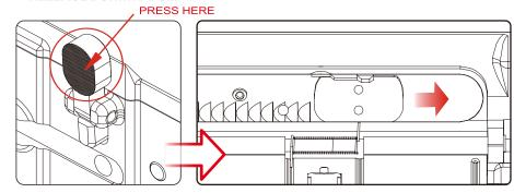
To Release bolt, just press the bolt catch. 按壓槍機釋放鈕,槍機飾片覆位。
